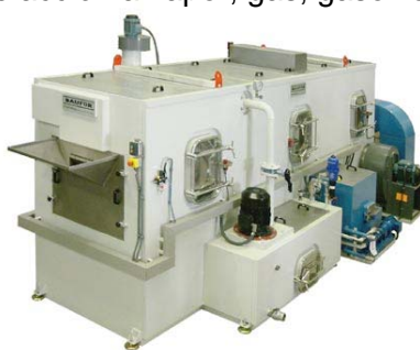
Zona de carga de una TT tambor.
