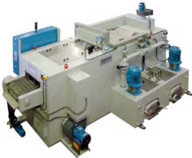
TB Túnel con dos depósitos para el lavado y secado.
