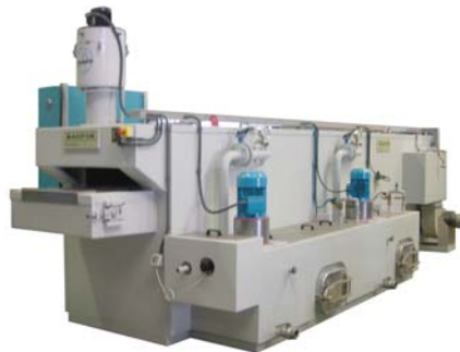
TB Túnel con tres cámaras: lavado, enjuague con depósitos independientes y secado.
