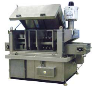
TB Túnel con carenado abatible, para el lavado y secado.
